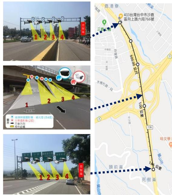
偵測車輛通過控制點所用的時間，若少於標準，即為超速；增加速度控制有效範圍，穩定路段的車行速度，減少失控肇事案件發生。
