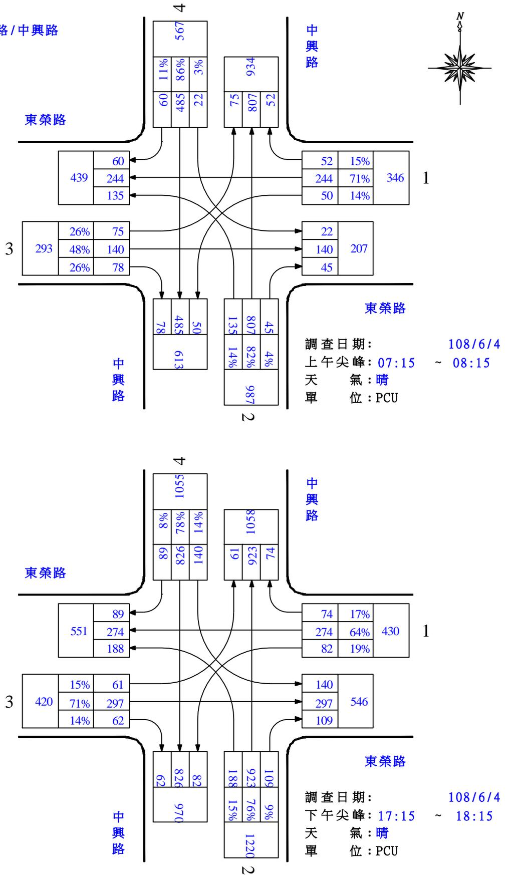
圖 2.4-2 平日上下午尖峰路口轉向交通量示意圖(續)
