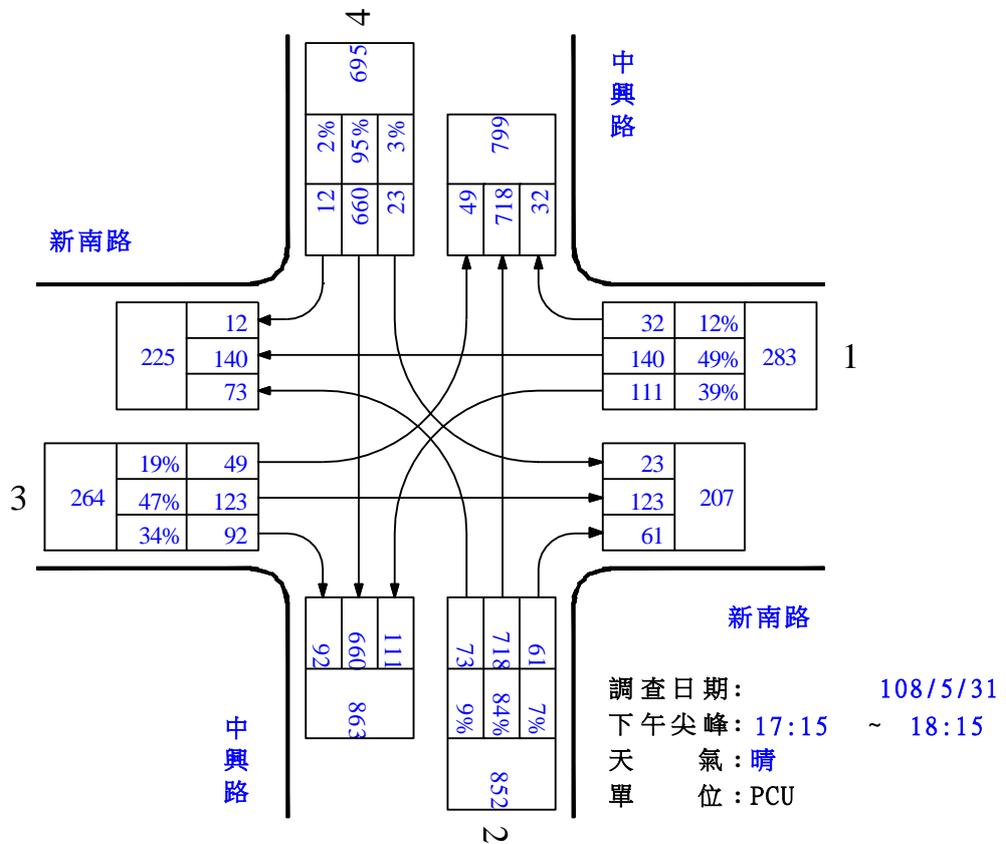
圖 2.4-2 平日上下午尖峰路口轉向交通量示意圖(續)
