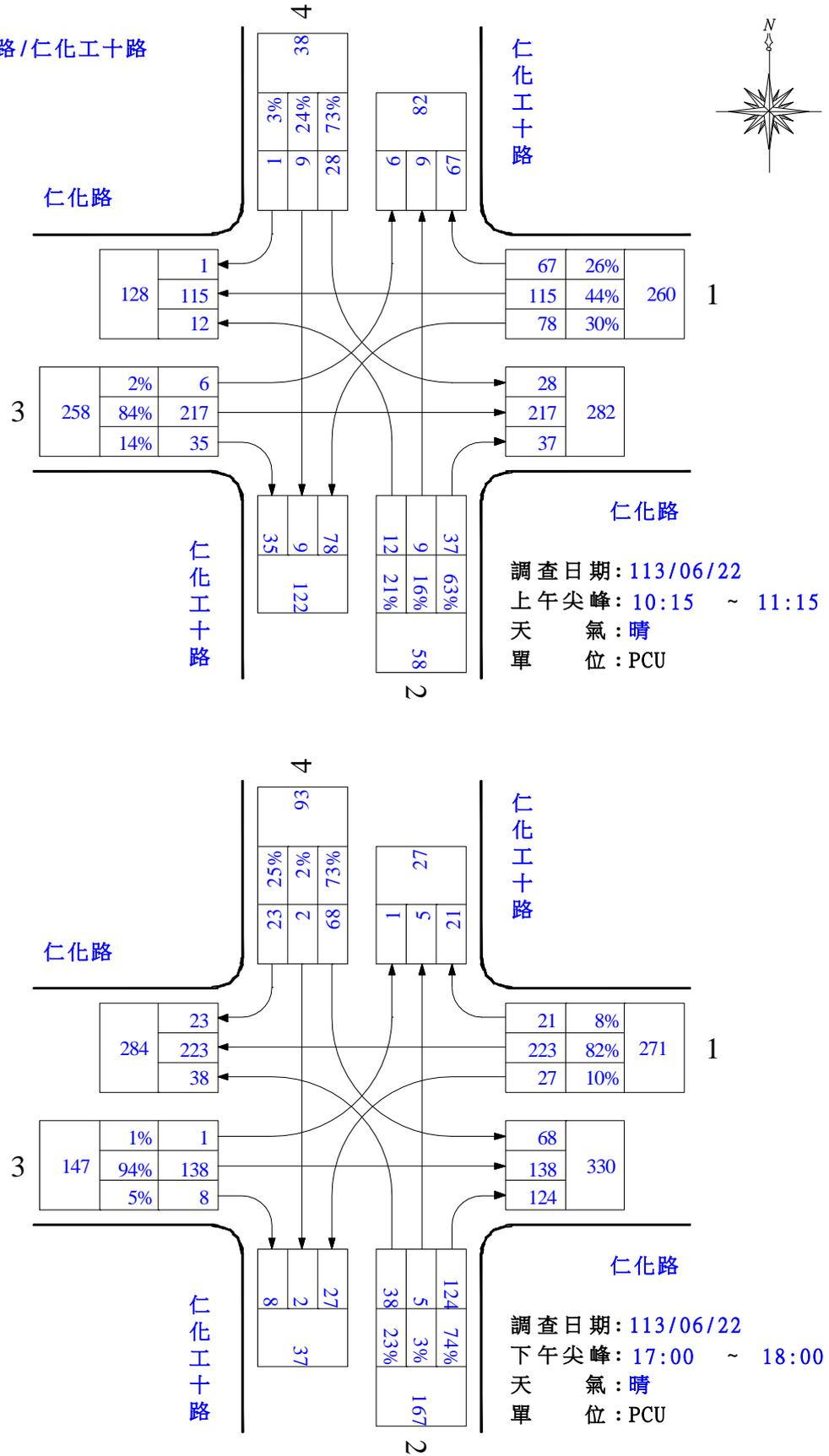
圖 2.4-6 仁化路/仁化工十路路口轉向交通量示意圖(假日尖峰)
