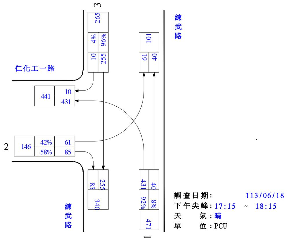
圖 2.4-5 練武路/仁化工一路路口轉向交通量示意圖(平日尖峰)
