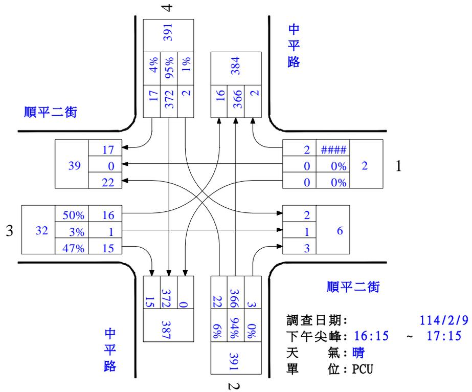
圖 1.1-9 順平二街/中平路路口轉向交通量示意圖(假日尖峰)
