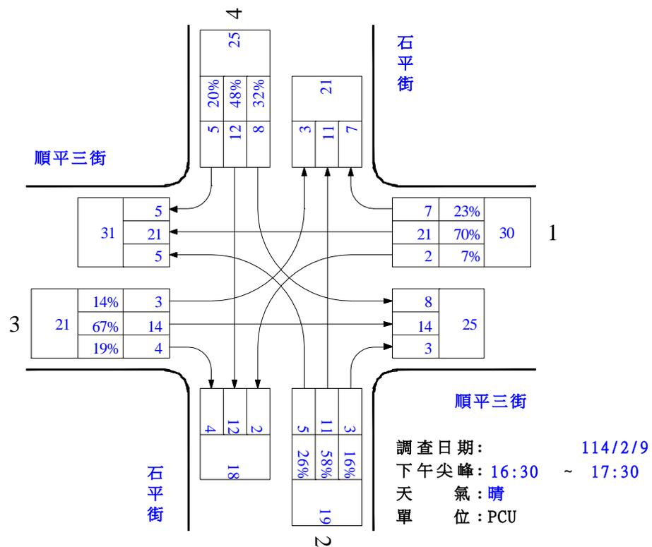
圖 1.1-11 順平三街/石平街路口轉向交通量示意圖(假日尖峰)
